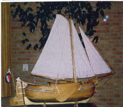
boven: Willem Bakker was als jongen scheepsmaat op de Ouderhoek . Hij bouwde een model op spanten (schaal 1 : 10) van de boeier en voorzag het model van het originele interieur. Het model kreeg geen houtsnijwerk (onder)
